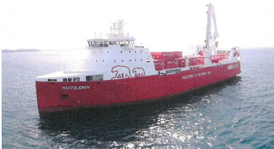
Nor Lines nye naturgassdrevne godsskip Kvitbjørn er det første av to nybygg som er ferdig bygd og har fått tilsagn om støtte fra NOx-fondet. Det er beregnet en forventet reduksjon på 304 tonn NOx redusert per år til sammen for de to skipene. Foto: Nor Lines
