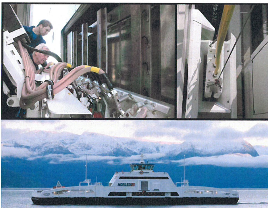
Norleds el-ferje Ampere som er verdens første bil- og passasjerferge på batteri. NOx-fondet har gitt tilsagn om støtte på inntil 10 millioner kroner til prosjektet. Øverst t.v.: Finjustering av pantografen. T.h: Ladepluggen på vei ned i kontakten. Foto: Tore Stensvold og Tor Arne Aasen
