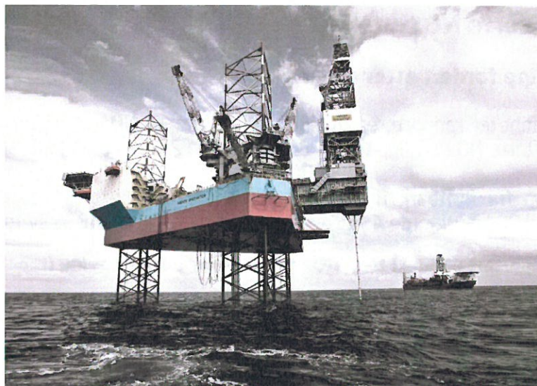
Riggen Maersk Innovator har installert SCR-anlegg med NOx-fondets støtte og har en verifisert reduksjon på 179 tonn NOx per år. Dette er den første SCR-installasjonen på en rigg. Foto: Maersk.
